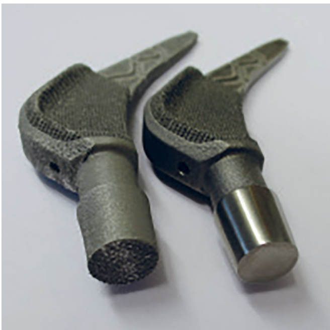
FIG. 5 Tige de hanche fémorale MUERTO® telle que construite (à gauche) et avec surface fonctionnelle polie (à droite) 7)
