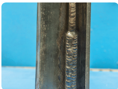
Soudage multi-passes en verticale montante
